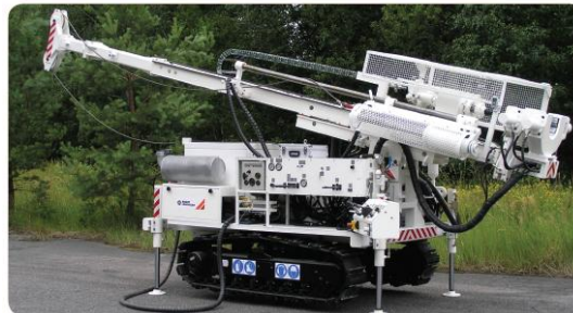
Fig. 3 – Sonda geotécnica LG-520.
