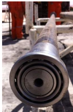
Fig. 9 – Rodamiento inferior, con sistema para conexión de veleta.
